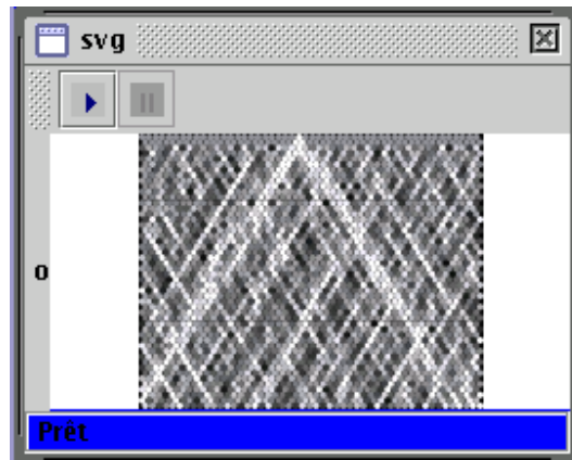
FIG. 6.3 – Visualisation au format SVG des charges des grains dans un tas Le tas est soumis à une surcharge sur un grain de la première couche. Les lignes de forces apparaissent en blanc sur le dessin.
