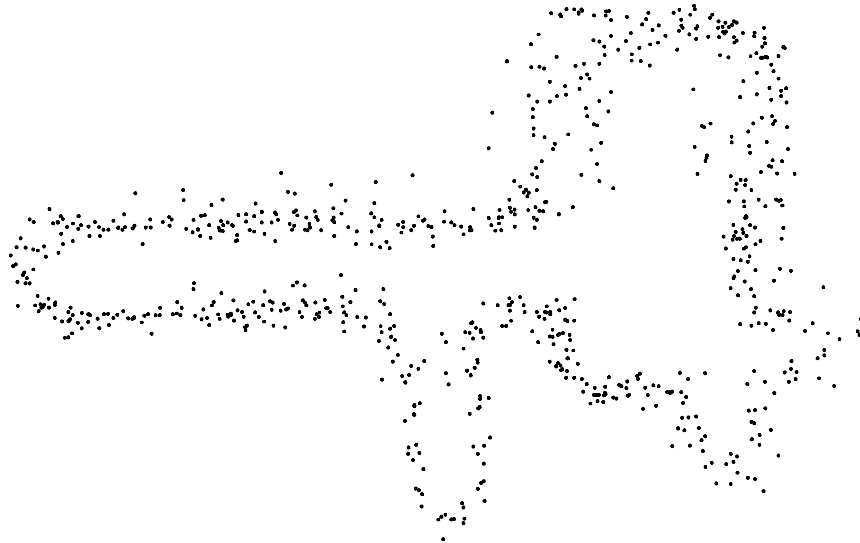
FIG. 6.13: Exemple de reconstruction de la structure de l'environnement à partir des informations mémorisées dans la carte. Les valeurs des sonars mémorisées dans chaque nœud sont utilisées pour tracer un point à la distance correspondante du nœud. L'environnement possédant essentiellement des murs selon deux directions, seuls les sonars perpendiculaires à ces deux directions sont utilisés. Les sonars formant des angles de 45 degrés avec ces directions, et qui ne renvoient pas des valeurs correspondant à des obstacles réels (cf. figure 6.12), ne sont pas utilisés.
