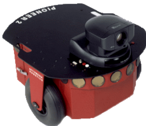
FIG. 6.1: Le robot Pioneer 2 utilisé pour nos expériences.
