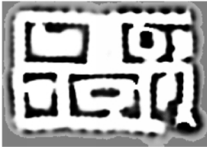
FIG. 1.7: Un exemple de grille d'occupation utilisée pour représenter un environnement. Les zones sombres indiquent une forte probabilité de présence d'un obstacle (Repris de [Thrun, 1999]).
